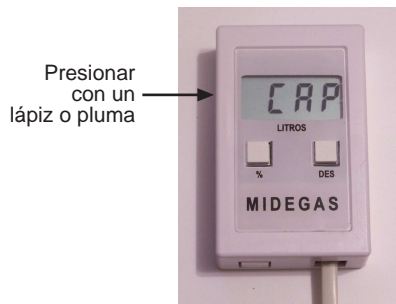
Inicio de progr. de capacidad
