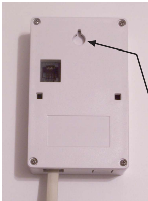
Orificio de gota para colgar el Medidor con un clavo, tornillo o clip sujetador transparente.
