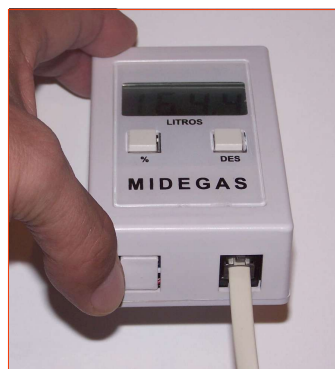
Cable extensión conectado
